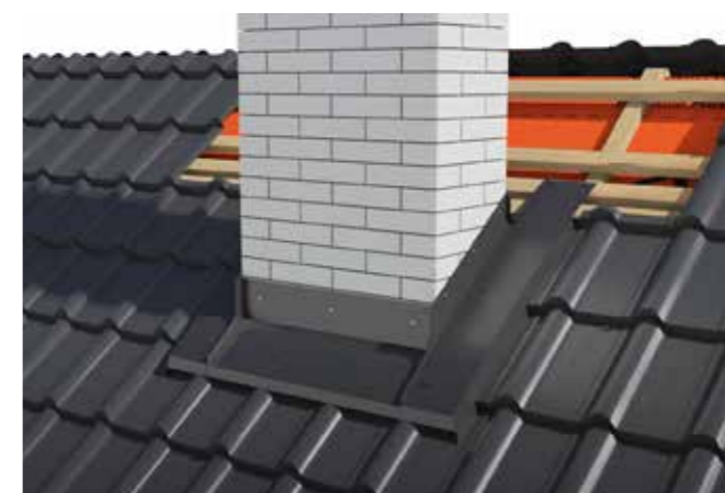
Rys. 20 Montaż obróbki komina – przedniej i bocznych.
