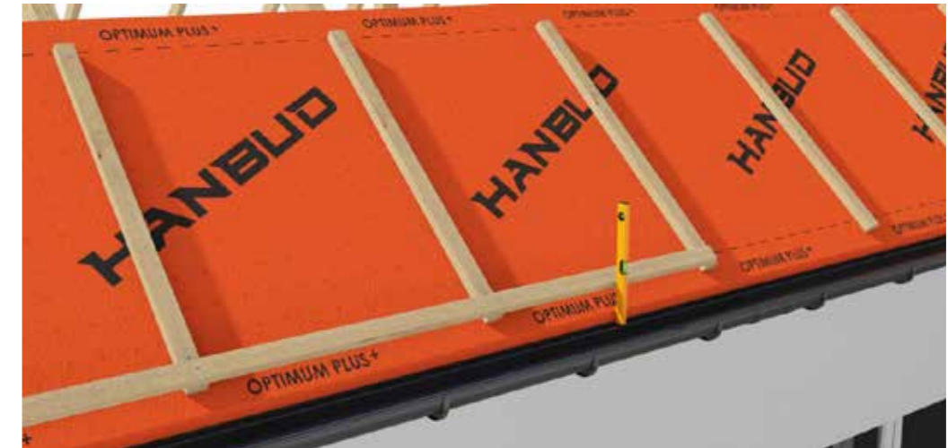
Rys. 7 Montaż kontrłat na połaci dachowej.
