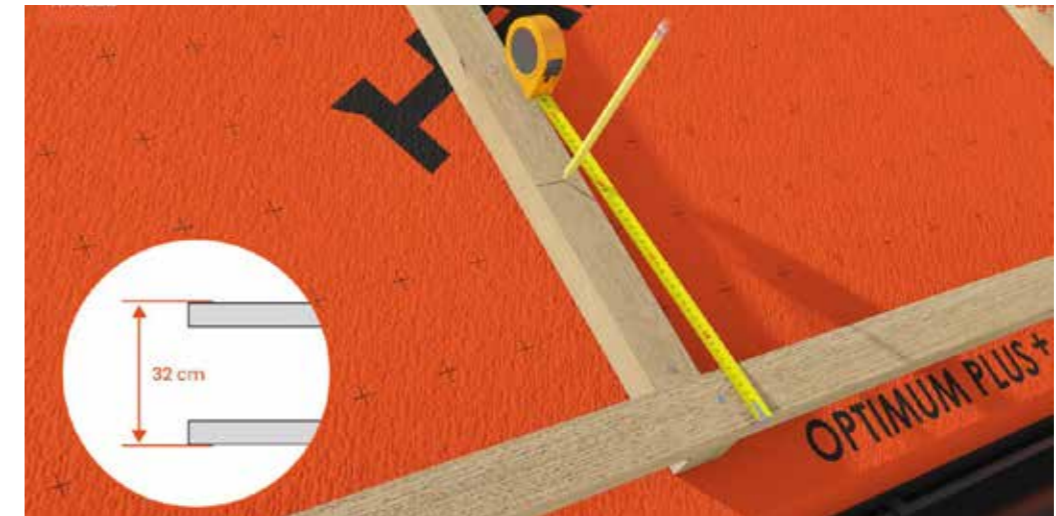
Rys. 8 Rozmieszczenie łat na połaci dachowej.
