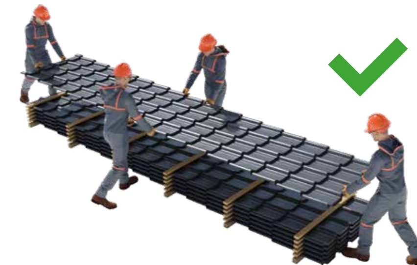
Rys. 2 Prawidłowy sposób transportu arkuszy blachodachówki.
