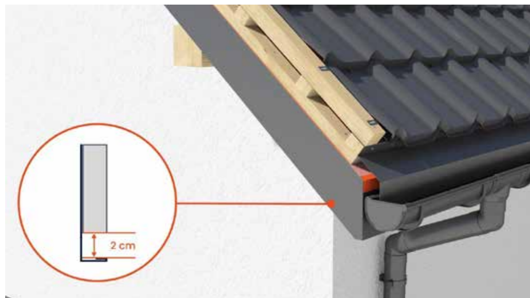
Rys. 18 Montaż wiatrownicy z zachowaniem 2-centymetrowego zakładu.
