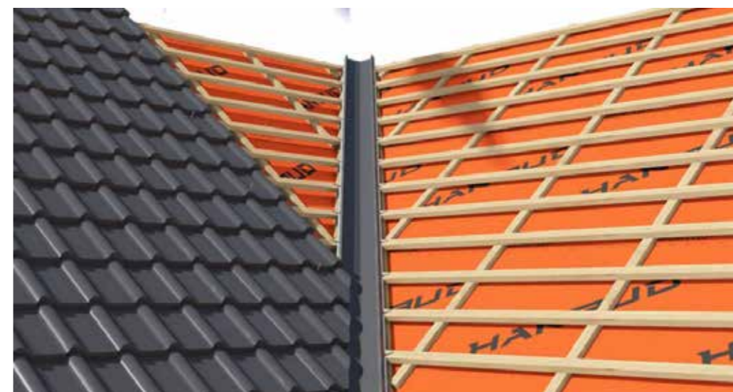
Rys. 17 Układanie arkuszy blachodachówki przy rynnie koszowej.
