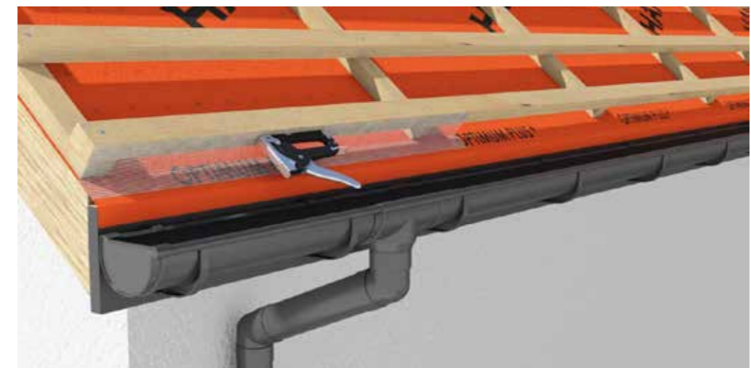
Rys. 9 Montaż siatki perforowanej, która zabezpiecza okap dachu przed owadami i zanieczyszczeniami.
