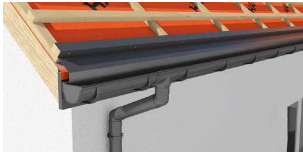
Rys. 10 Prawidłowy montaż pasa nadrynnowego.
